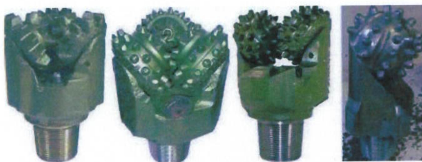
Figura 4: Tipos de brocas de cones. Da esquerda para a direita: Tricônica de dente de aço, tricônica de insertos, bicônica e monocônica (REGALLA apud PLÁCIDO et al., 2011).
